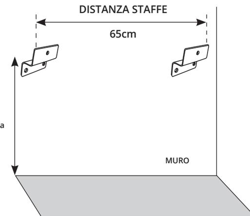
Fissare a muro le 2 staffe di supporto del mobile.
