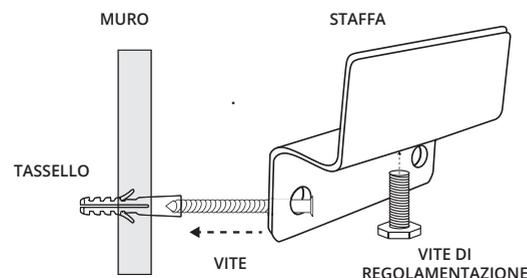
Appoggiare il vano a giorno sulle staffe metalliche e segnare sul muro i due fori F delle piastre angolari (già fissate all'interno del mobile). Togliere il mobile, effettuare i fori sul muro con una punta 8mm x 70mm
